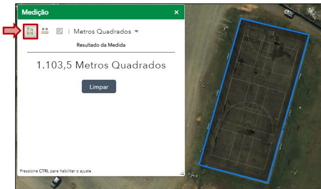
FIGURA 29 – FERRAMENTA MEDIÇÃO - ÁREA
